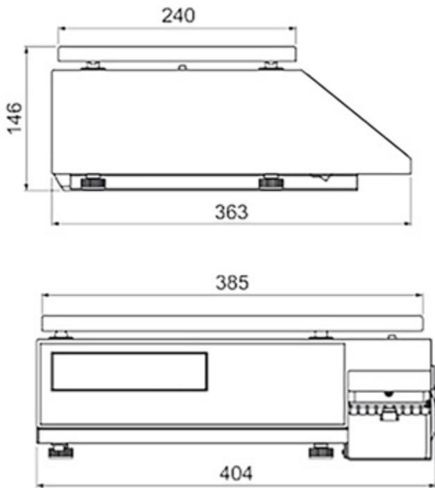
Abmessungen in mm gewicht: 11,4 Kg
