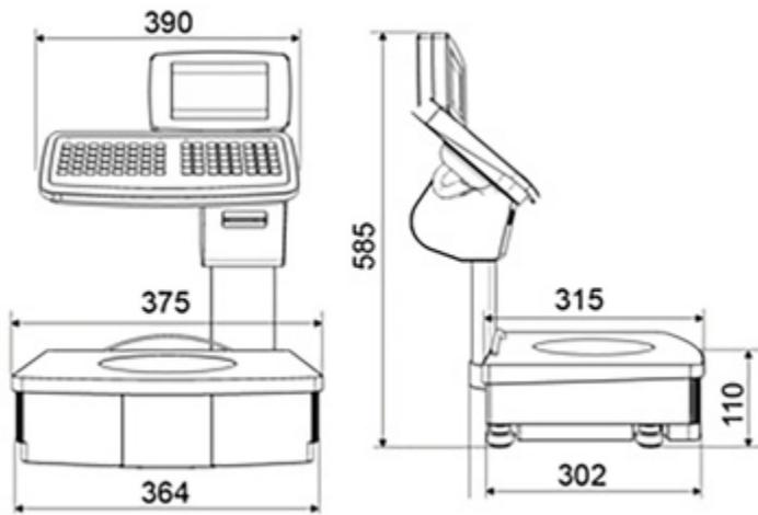
Abmessungen in mm gewicht: 14,0 Kg
