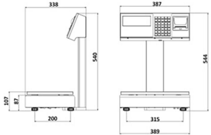
Abmessungen in mm gewicht: 11,6 Kg
